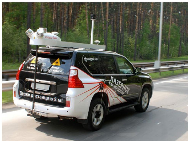
Рис. 4. Общий вид лазерной сканирующей лаборатории
